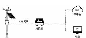
使用 RJ45 以太网传输，可直接将数据传输到服务器，连接中泰能云平台使用电脑或者组态软件查看数据。
